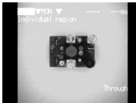
Rysunek Sekwencja Rysunek. Poprawne umiejscowienie i orientacja elementu.
